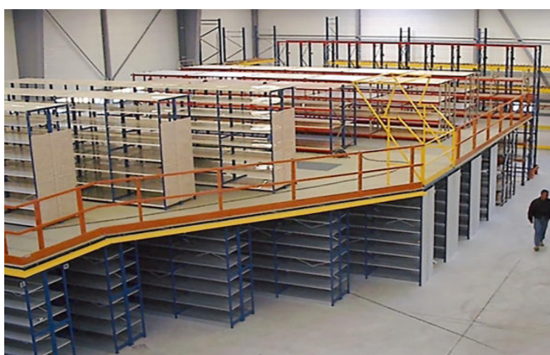
Plate-forme de stockage
